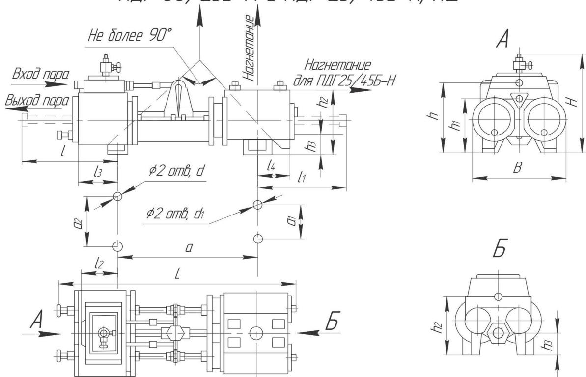
*Габаритный чертеж насосов ПДГ 25/45Б-НГ, НГш,
